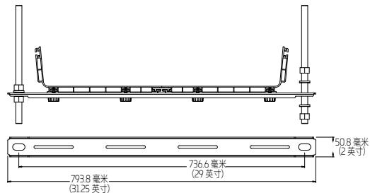
新型 5/8 英寸螺纹杆梯型支架套件
