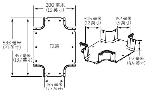
带 (两个) 6 英寸出口的水平十字型接头
