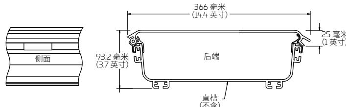
用于水平直槽的铰链式盖板
