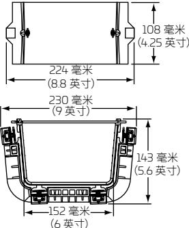
Snap-Fit 卡扣式连接件组件
