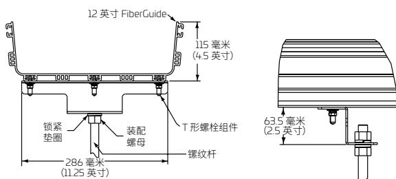
中心支撑螺纹杆支架套件
