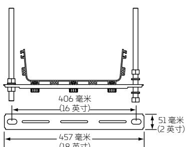
全新螺纹杆梯型支架套件
