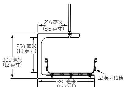
顶部支撑螺纹杆 C 形支架套件
