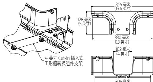
4 英寸 Cut-in 插入式 T 形槽
