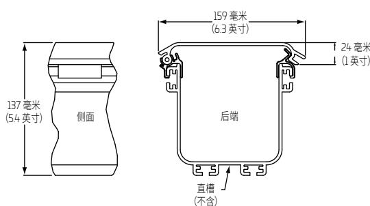
用于 4 英寸水平直槽的铰链式盖板
