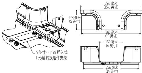
6 英寸 Cut-in 插入式 T 形槽
