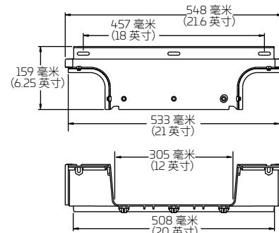
12 英寸 Cut-in 插入式 T 形槽
