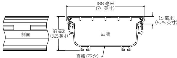
水平直槽的卡入式盖板
