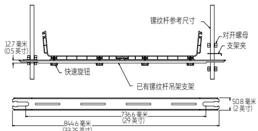
已有 5/8 英寸全新螺纹杆梯型支架套件
