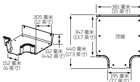
带 (单个) 6 英寸出口的水平三通 T型接头
