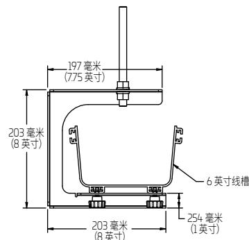
**顶部支撑低高度 C 形支架**
