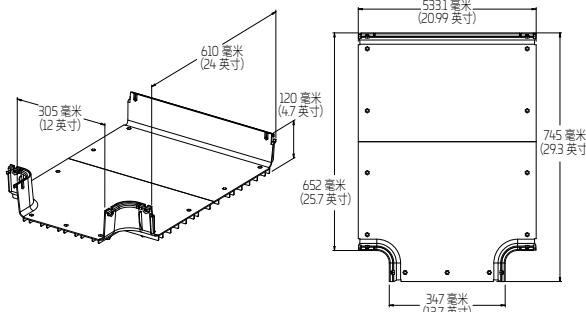
带单个 12 英寸出口的水平三通 T 型接头
