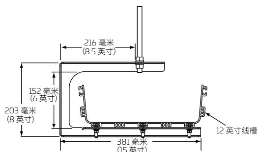
顶部支撑低高度螺纹杆 C 形支架套件
