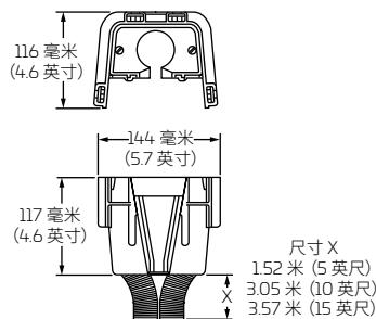
带软管的 4 英寸方形转 2 英寸圆形转换组件
