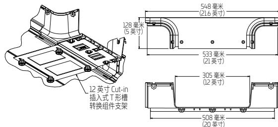
12 英寸 Cut-in 插入式 T 形槽
