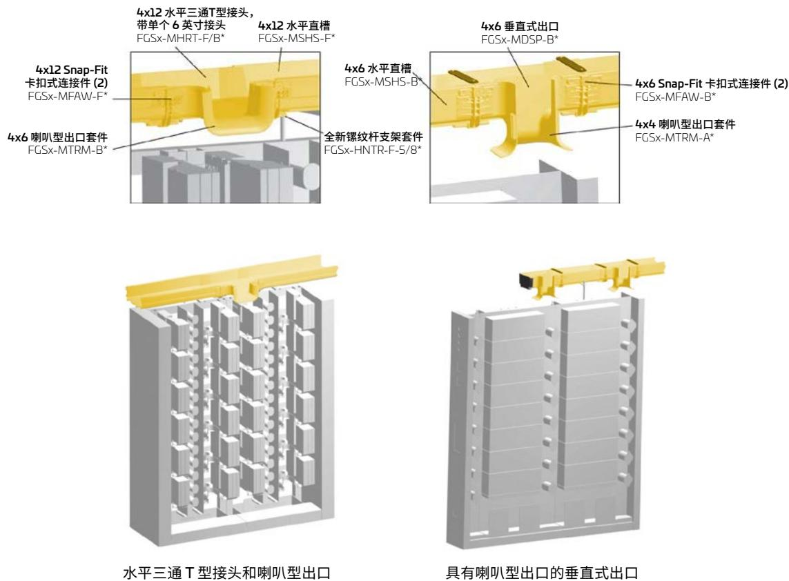
在将直槽或配件连接到 4x4 或 4x6 垂直式出口时，必须使用 FGS-MJWR-A 连接件。此连接件仅在连接垂直部件时才需要用到，在连接水平部件时可以使用 FGS-MFAW-x 连接件。
