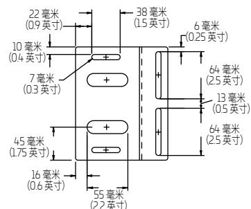
OMX 框架中心支撑支架套件
