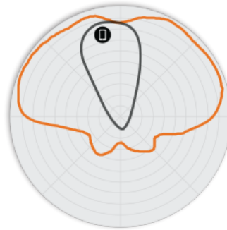
РИСУНОК 4 Вертикальная плоскость 2,4 ГГц R710 Диаграммы направленности антенны
