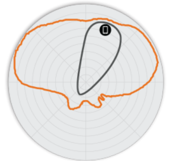
РИСУНОК 5 Вертикальная плоскость 5 ГГц R710 Диаграммы направленности антенны
