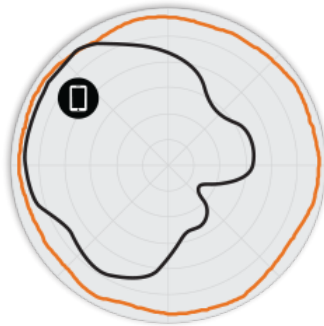
РИСУНОК 3 Азимутальная плоскость 5 ГГц R710 Диаграммы направленности антенны
