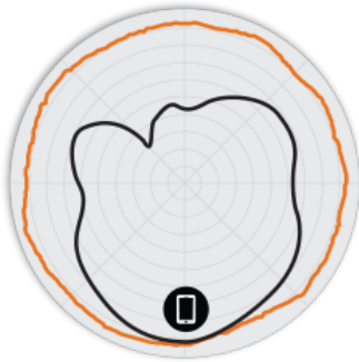
РИСУНОК 2 Азимутальная плоскость 2,4 ГГц R710 Диаграммы направленности антенны
