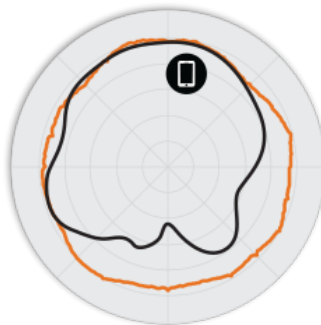
Рисунок 3. Азимутальная плоскость 5 ГГц R310 Диаграммы направленности антенны
